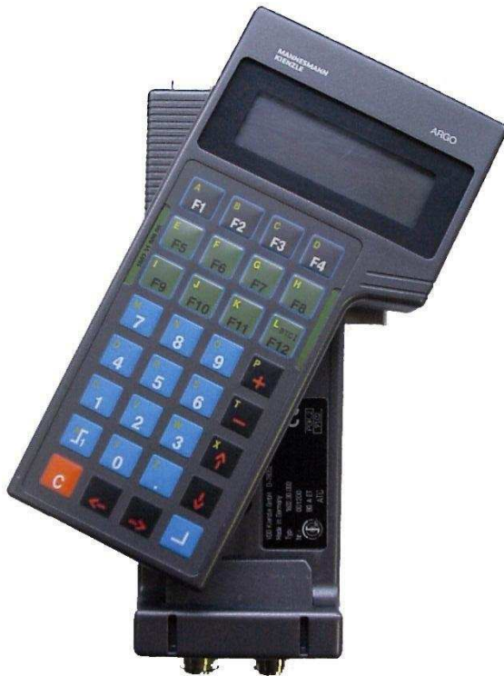
Terminal de commande et d'affichage avec son support interface (vue avant) certificat n° LNE-17964 rév. 0
